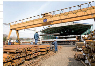
大型の門型クレーン
